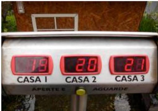
Figura 22: visor digital das temperaturas internas tiradas pelos medidores dos elementos prototípicos
