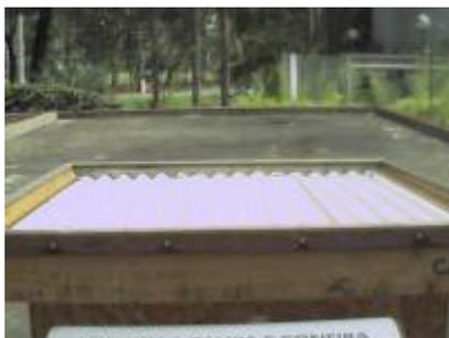
Figura 26: Elemento prototípico Cobertura Telha de Fibrocimento
