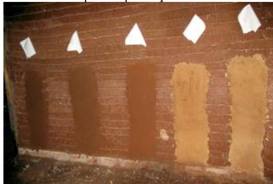
Figura 12: Teste 1 a 5 para a composição do material para os trabalhos de reboco.
