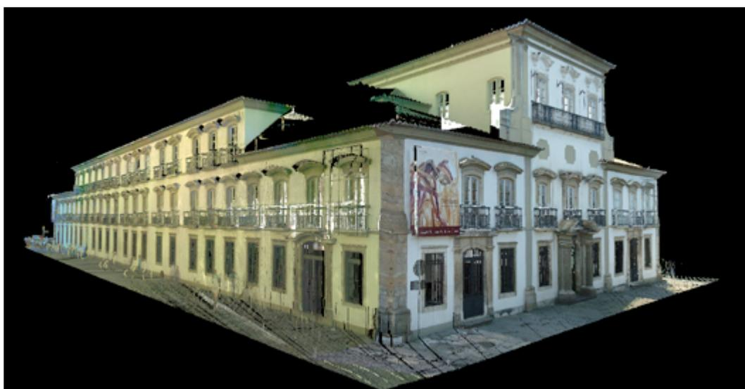
Figura 5 – Modelo 3D do Paço Imperial. Nuvem de pontos modificada pela justaposição de imagem fotográfica de baixa resolução no trecho à esquerda da fachada principal
